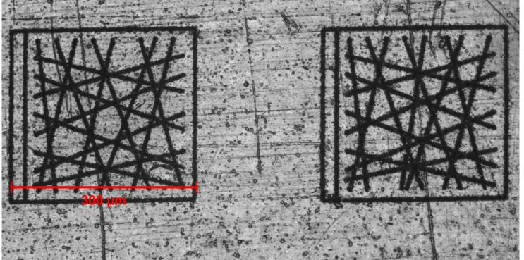
40 mm/s - 10 kHz line width ~5 μm
